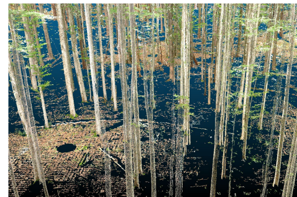
Nor de puncte achiziționat cu laser terestru static (TLS) PN 23 09 02 04
