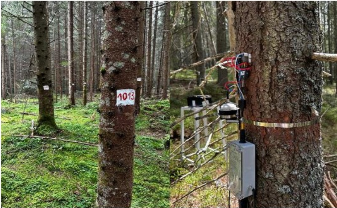
Imagine de ansamblu din suprafața nou instalată Demacușa – Molid (stânga) și sistem sap flow cu dendrometru automat tip bandă integrat de monitorizare a fluxului de sevă și a creșterilor în diametrul (dreapta)
