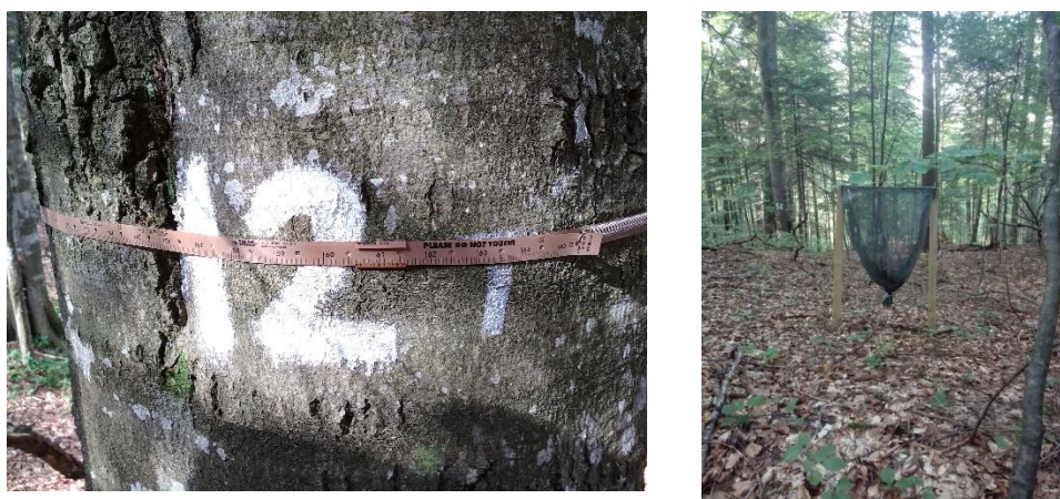
Fig. 3 Măsurarea creșterii în diametru cu banda dendrometrică; colectoare de litieră.
