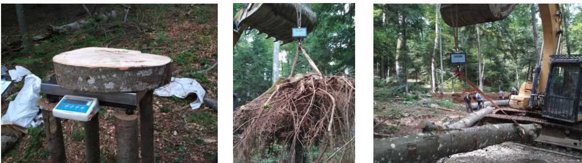
Fig. 2 Cântărirea rondelor, rădăcinilor și a tronsoanelor de lemn mari cu cântarul platformă și cântarul cârlig
