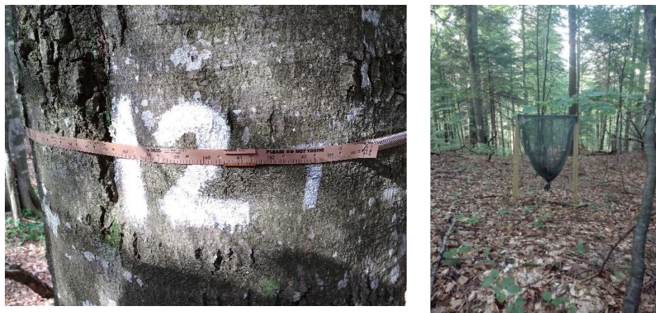
Fig. 1 Măsurarea creșterii în diametru cu banda dendrometrică; colectoare de litieră.
